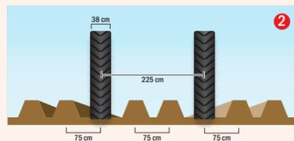
При работе с шириной колеи 225 см и используя широкие шины, для лучшей стабильности, происходит повреждение рядков.
