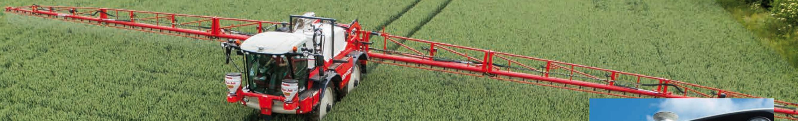
Использование GPS в качестве поддержки оптимальной защиты посевов является необходимостью. Функция автоматического управления секциями, регистрация обработанной площади, а так же автоматическое рулевое управление позволяют увеличить эффективность защиты.
