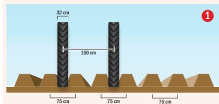
Опрыскивание с шириной колеи 150 см. Для лучшей устойчивости нужно работать с шириной колеи 225 см.
