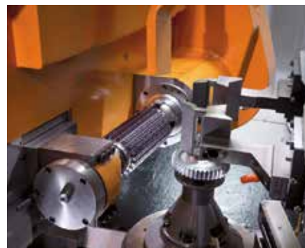
Зубофрезерный станок с автоматической подачей заготовок. Производство механизмов
