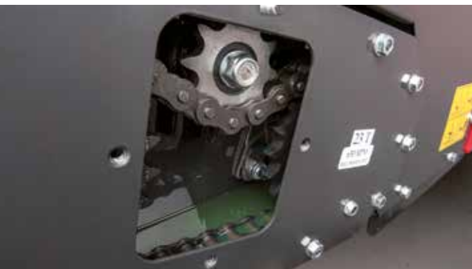
Элемент привода с системой смазки с помощью масляной ванны: без ограничения срока эксплуатации. Нет необходимости в смене цепей.
