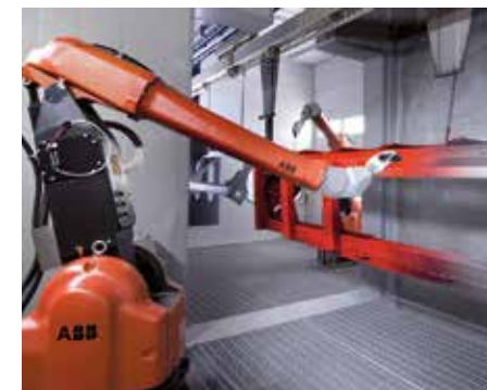
Один из роботов, наносящих лаковое покрытие
