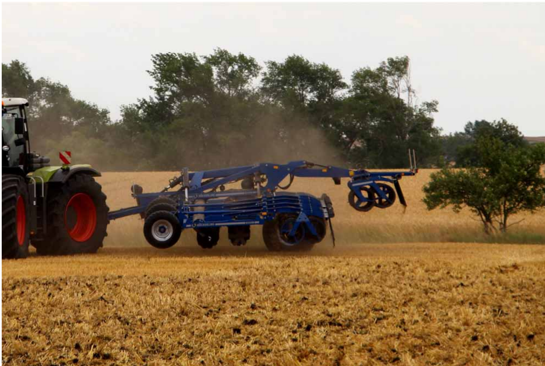
Rebell classic 1250T / маленький радиус разворота По причине встроенной транспортной шасси в машину.
