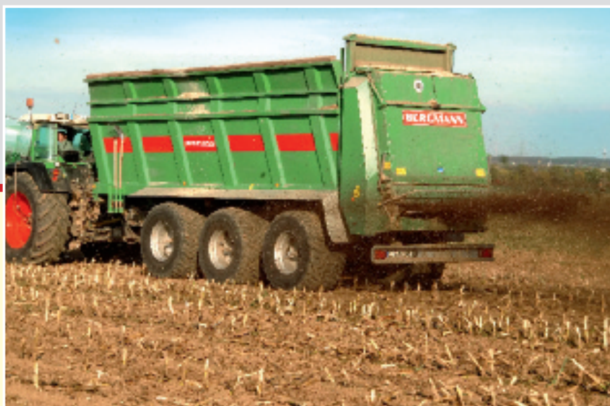
TSW A 21 Специализированный кузов (емкость около 34 м 3 )
