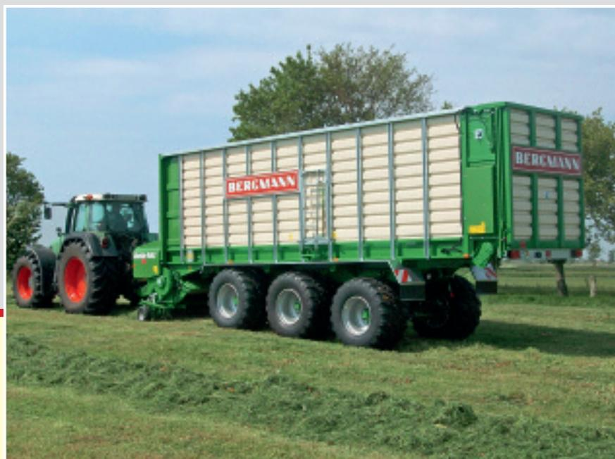
Шины с большим объемом и малым поперечным сечением служат гарантией хорошей проходимости как по полю так и по дороге, не уплотняя почву.
