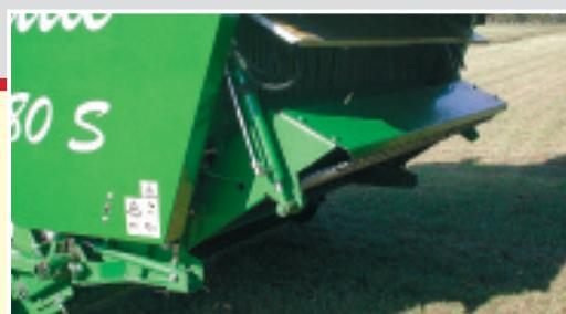
34 мм. длина резки обеспечивает высокое качество измельчения кормовой массы. 53 ножа режущего агрегата монтируются и демонтируются в течении нескольких минут без инструментов. Каждый нож имеет индивидуальный механизм защиты от инородных тел.
