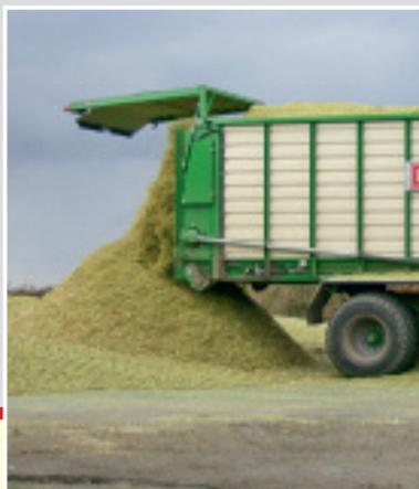
Система быстрой выгрузки с 2 или 3 «агрессивными» дозирующими барабанами.
