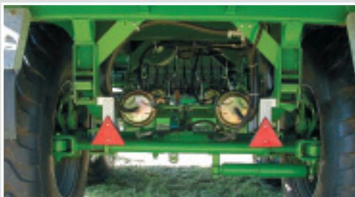
Тандем агрегат с трехслойными параболическими рессорами и блокировкой поворотной оси следящего типа обеспечивает лёгкость и устойчивость передвижения, как на дорогах так и при разгрузке на силосных хранилищах. Серийно оснащён пневматической системой тормозов с автоматическим зависящем от нагрузки регулятором.
