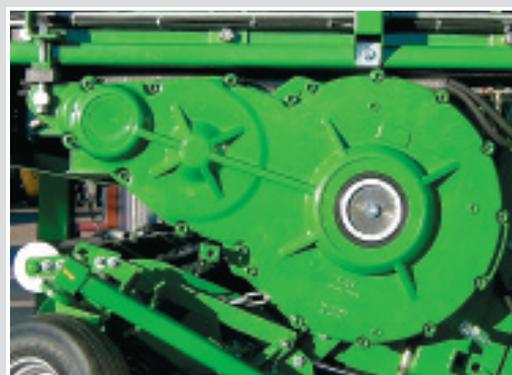
Стабильный, плавающе подвешенный редуктор в масляной ванне с приводным валом диаметром 120 мм. предусмотрен для работы с мощными тракторами.
