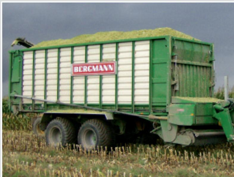
Shuttle-мультиприцеп: Самозагружающийся или просто прицеп для транспортировки силоса. Прицеп с боковыми надставками, гидравлически складывающимся Щитком на передней стенке и защитным щитком ротора используется просто для транспортировки силоса.
