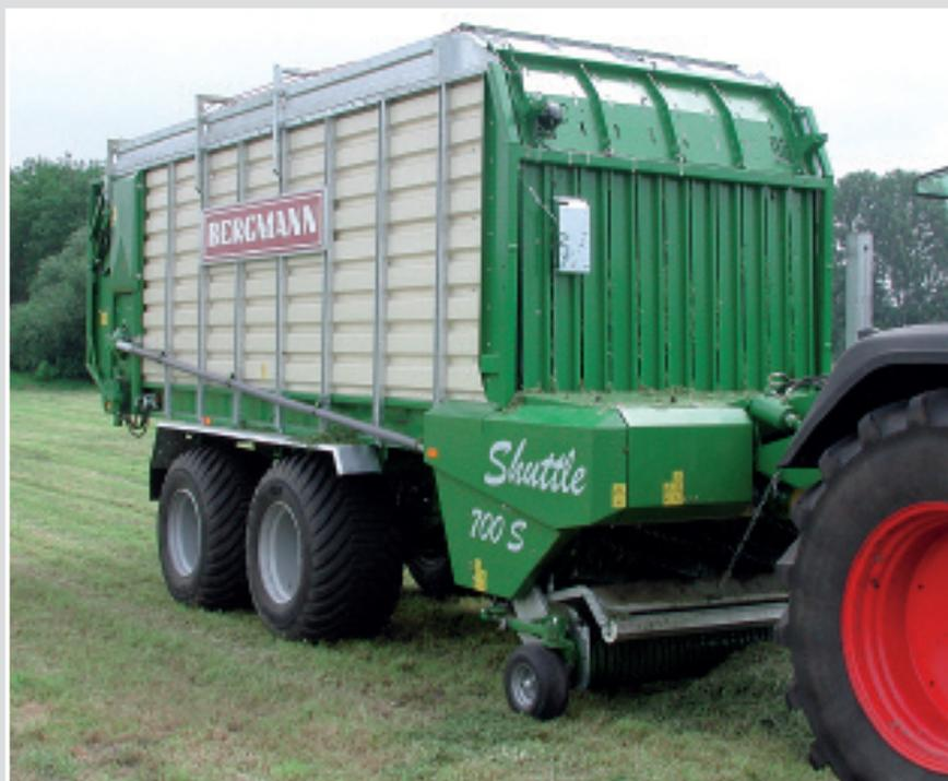
Верхняя конструкция Shuttle разработана по новой технологии. Несущий корпус цельнометаллической надстройки, полимерные и оцинкованные трапецевидные борта кузова гарантируют длительный срок эксплуатации. Для оптимальной разгрузки кормовой массы на передней стенке установлен индикатор положения заднего борта.
