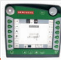
Опционально предлагается ISO-BUS-способный терминал CCI 200, с большим дисплеем, сенсорный экран и 12 функциональных клавиш.
