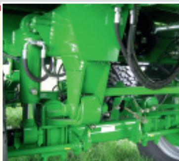
Гидростатическая подвеска колес обеспечивает равномерную нагрузку на колеса. Большой ход колес (до 300 мм) обеспечивает хорошие ходовые качества даже на пересеченной местности.
