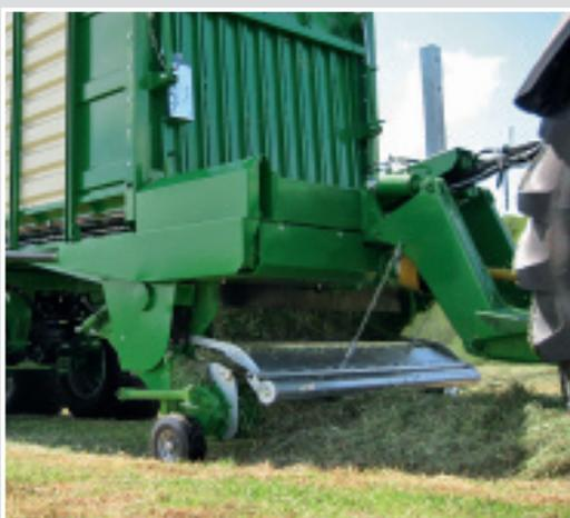
Pick up оснащённый вальцевым прижимом обеспечивает оптимальную подачу кормовой массы, используя при этом полную ширину захвата. Располагает скользящей муфтой предохраняющей от перегрузки.
