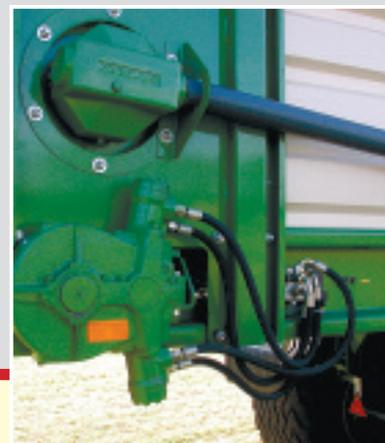
Конвейерное днище с реверсом в серийном исполнении, приводится через двухступенчатый гидравлический привод с режимом ускоренного движения. Привод барабана осуществляется от навесного конического редуктора.
