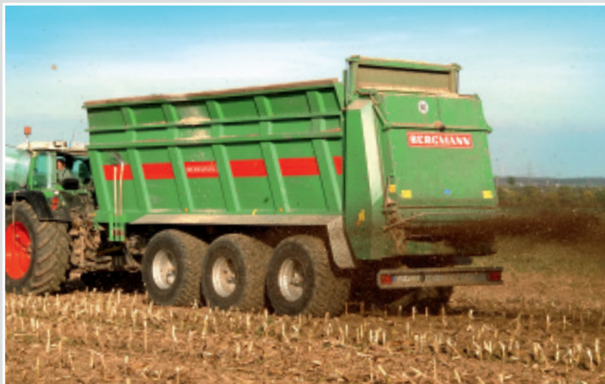
TSW A 21 сменный разбрасыватель с доп. бортами (до 34 м 3 )
