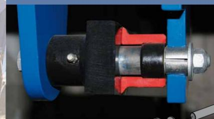
Все важные узлы крепления соединены болтами системы «ЛокПин». Принцип: Обычное соединение пальцами заменяет ось. На конусные концы оси вставляются высококачественные втулки. С помощью болта втулки втягиваются, спрессовываются и фиксируются в кронштейне.
