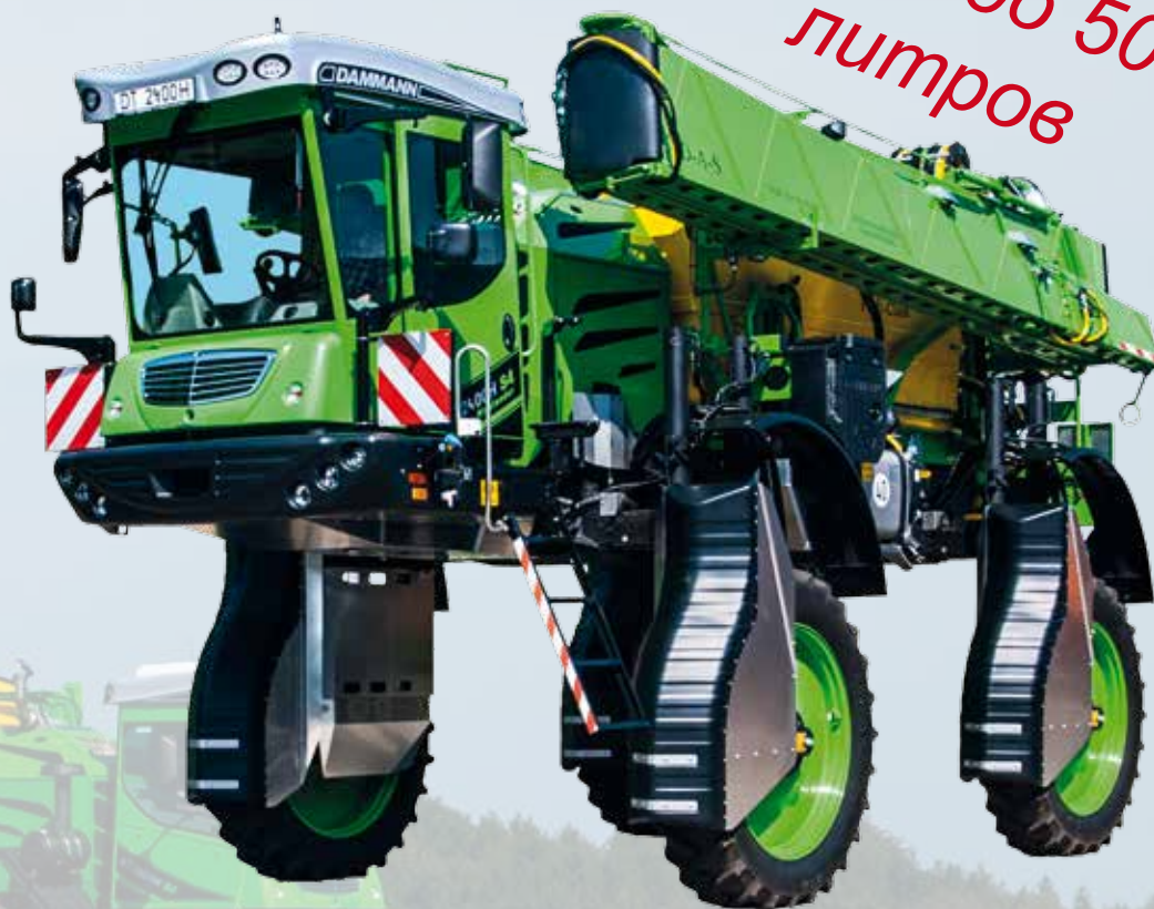
DAMMANN-trac DT 2400H S4 „Highlander“ EcoDrive™ „Универсальный“ – колея и клиренс регулируются прямо из кабины.
