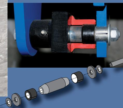
Все важные узлы крепления соединены болтами системы «ЛокПин». Принцип: Обычное соединение пальцами заменяет ось. На конусные концы оси вставляются высококачественные втулки. С помощью болта втулки втягиваются, спрессовываются и фиксируются в кронштейне.
